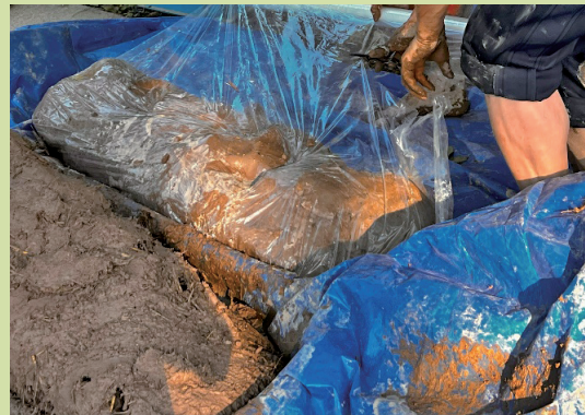
【写真5】100 kg 毎に、湿度低下を抑えるために農業用シートで包み、約1ヶ月寝かし、発酵させる。水合わせと呼び藁の成分や発生した菌により粘性が増す。
