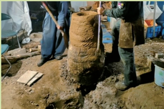
【写真6】発酵した土でブロックを作り、築炉する。
