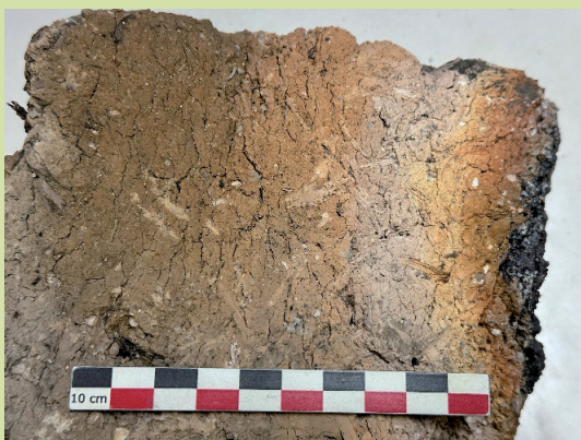
【写真8】炉壁の断面。炉壁は耐火性により十分な活躍を果たした。炉内面（右）が溶岩のようにスラグ化し、白い帯は操業中に還元する環境により発生した。色の变化は焼かれた温度と環境（土内の湿気や藁の炭化など）の総合関係を表す。
