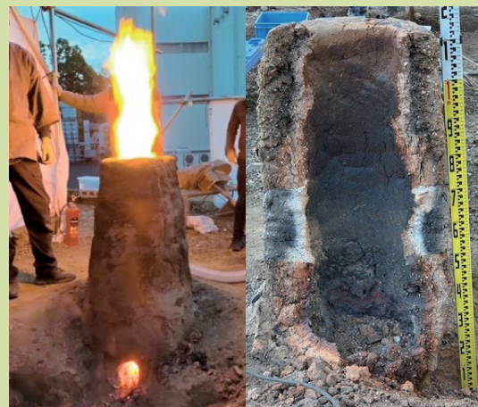
【写真7】操業中（左）に炉の上から砂鉄と木炭を投入し、下から溶岩のように溶けた鉄滓（スラグ）や鉄が流出。操業後（右）に炉壁を破壊し、炉底に溜まった鉄塊を回収する（実験のため、炉を半分に切断し、写真は炉壁の断面を表す、真ん中あたりの白色部分は比較の為に用いた耐火粘土）。
