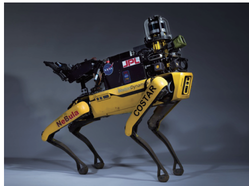
【図5】 NeBula-SPOT. NASA/JPL-Caltech, Boston Dynamics 製 4 脚ロボット Spot に JPL (NASA ジェット推進研究所) の統合モジュール型ソフトウェアシステム「NeBula」を組み合わせた試作機 NeBula-SPOT. DARPA Subterranean Challenge を契機に開発された。DARPA Subterranean Challenge は、GPS が使えないトンネル、都市地下、洞窟等で、ロボットが自律的に探索を行うことを想定したチャレンジプログラム
