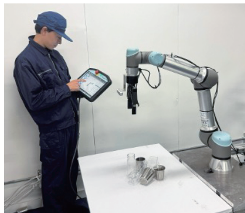
【図6】 ティーチングペンダントで関節角を登録する様子
