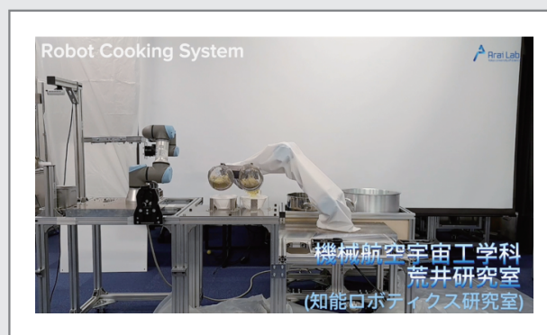
【図 12】麺類自動調理システム。著者の研究室に配属された学部 4 年生が最初に取り組む課題の一つ。構築されたシステムを使って調理したラーメンを大学祭で実演販売している。1 日約 8 時間連続でシステムを稼働させる必要があり、信頼性も要求される。毎年、システムの機能追加がある
